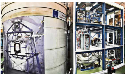
Au laboratoire national du Gran Sasso, dans les Abruzzes (Italie), le détecteur, plongé dans son château d'eau, avec, à droite, le bâtiment de trois étages abritant ses systèmes auxiliaires. (30)
